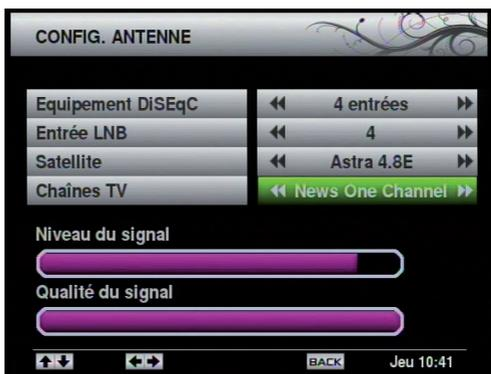
**Équipement DiSEqC:** Si vous avez de multiples antennes paraboliques et un commutateur DiSEqC, vous pouvez sélectionner ce type d'antenne. Vous pouvez régler sur **None (Aucun)**, **2-Way Switch (Commutateur à 2 voies)** ou **4-Way switch (commutateur à 4 voies)**.
